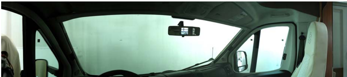
Die 180° Ansicht vom Fahrer aus verrät: Der Blick nach draußen ist ab der B-Säule nur über die Außenspiegel möglich
